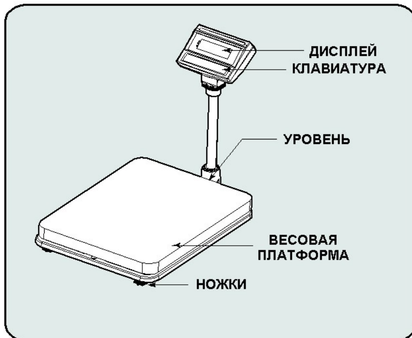
Рис. 5.1 - Внешний вид и основные элементы весов HD
